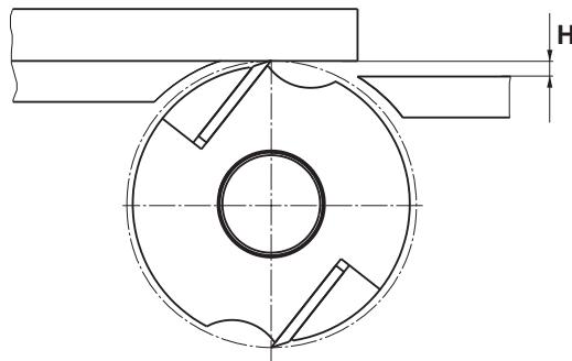
**Рисунок 8.** Схема регулирования ножей
