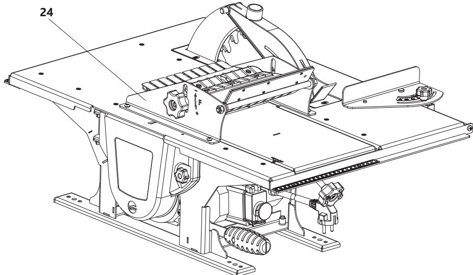
**Рисунок 4.** Общий вид станка с установленным устройством прижимным
