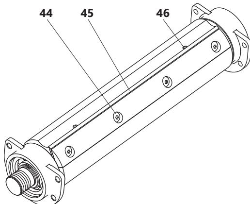
**Рисунок 7.** Общий вид ножевого вала
